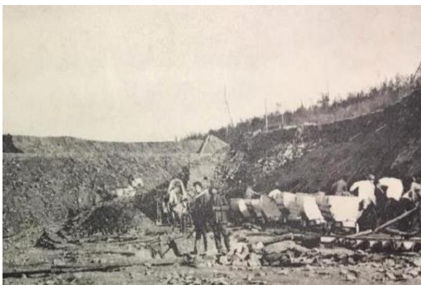
На прииске: золотосодержащий грунт грузят в тележки и везут к промывальной машине.
