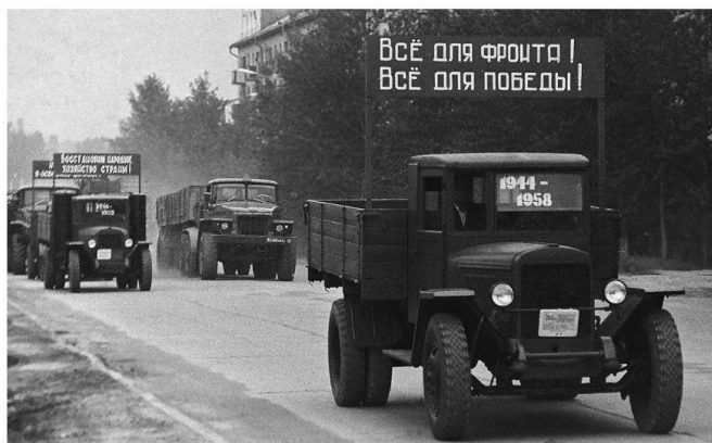
ЗИС-5В: легендарный «Захар» в годы войны выпускался в упрощенном варианте с деревянной кабиной.
